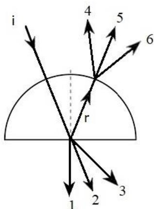
Ao penetrar no semicilindro, a luz é parcialmente refletida na superfície plana interna, raio  $r$ , e parcialmente refratada para o ar.
